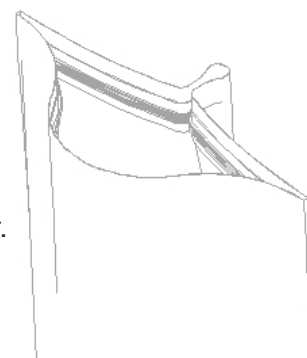
Pliage pour la création du bec verseur.
